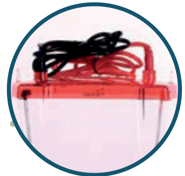
Depósito moldeado simple con tapa de seguridad y localizadores de pulgares
